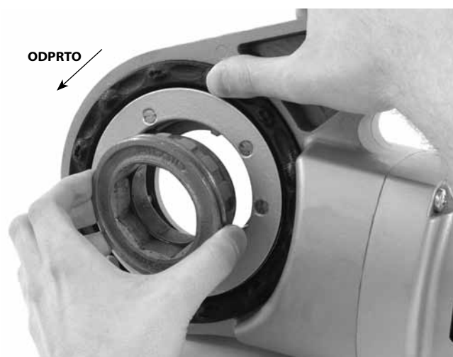
Slika 8 – Vstavljanje prilagodilnika v 690-I
