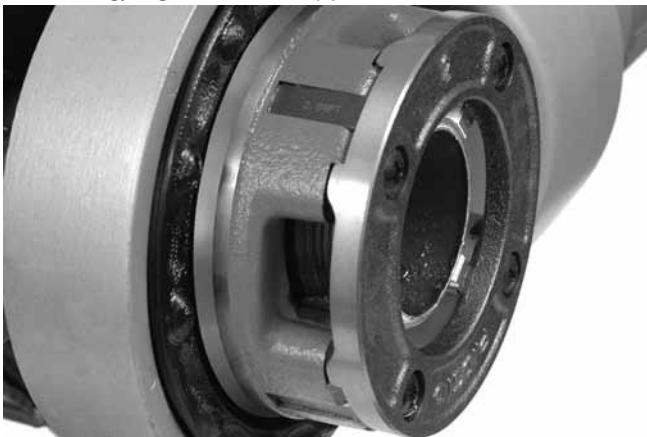
Figur 15 – rør jevnt med kanten på gjengebakkene
