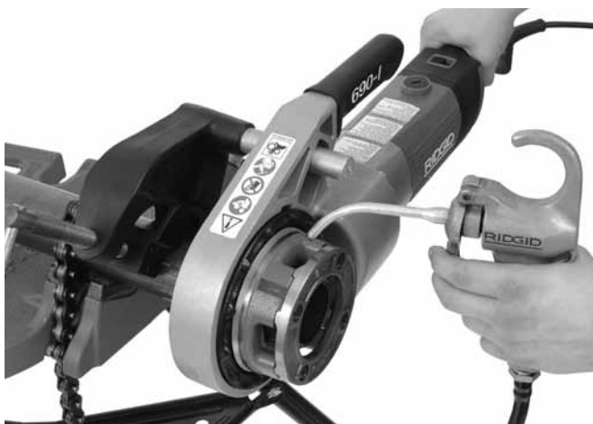
Figura 14 – Tubo de Roscagem
