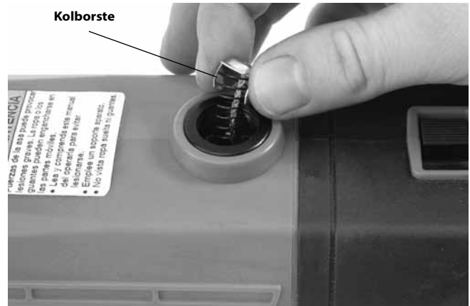
Figur 18 – Montering av kolborstar
