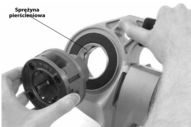
Rys. 9 – Montaż głowic gwinciarских na napęd elektryczny 600-I
