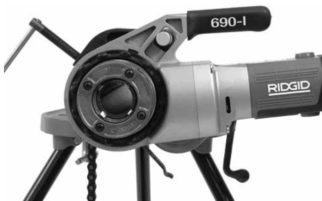
Kuva 12 – Käyttölaitteen oikea suuntaus
