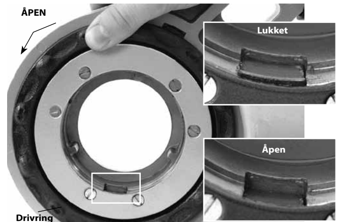
Figur 7 – holdemekanisme, drivring i åpen/lukket stilling
