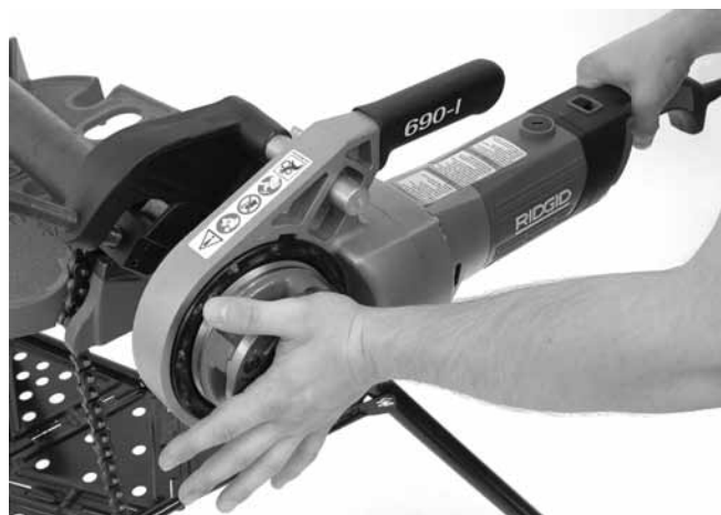
Obrázek 13 – začátek řezání závitů
