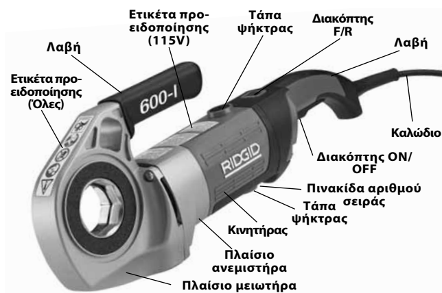
Εικόνα 1 – Μοντέλο 600-I ηλεκτρικού βιδολόγου
