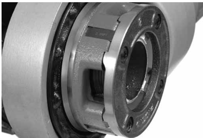
Obrázek 15 – trubka zarovnaná s okrajem řezných matic
