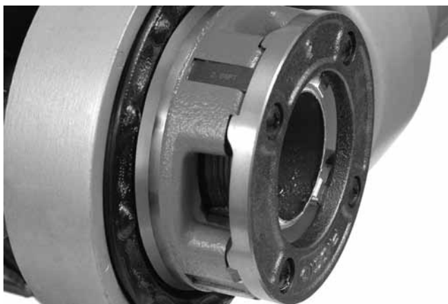
Obrázok 15 – Rúra vyrovnaná s hranou závitníč
