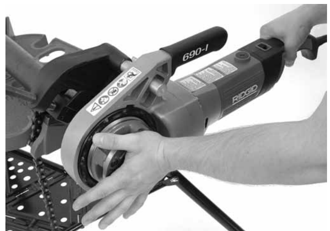
Figura 13 – Avvio della filettatura
