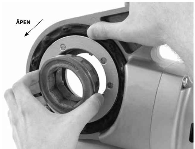
Figur 8 – installere adapter i 690-I
