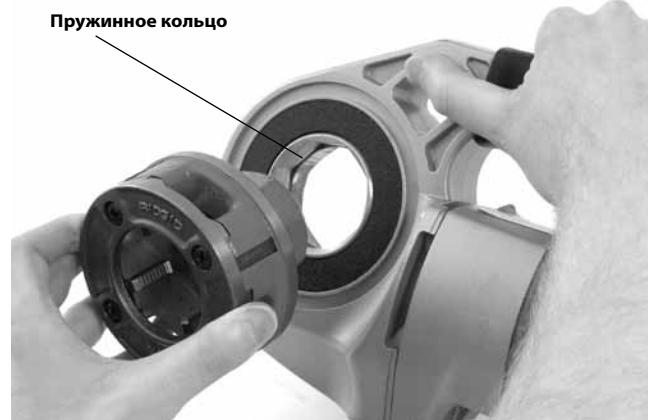
Рис. 9 – Установка резьбонарезных головок в силовой привод 600-I
