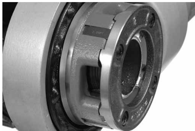
15-сурет – Құбыр кескіш жиектерімен бір деңгейде
