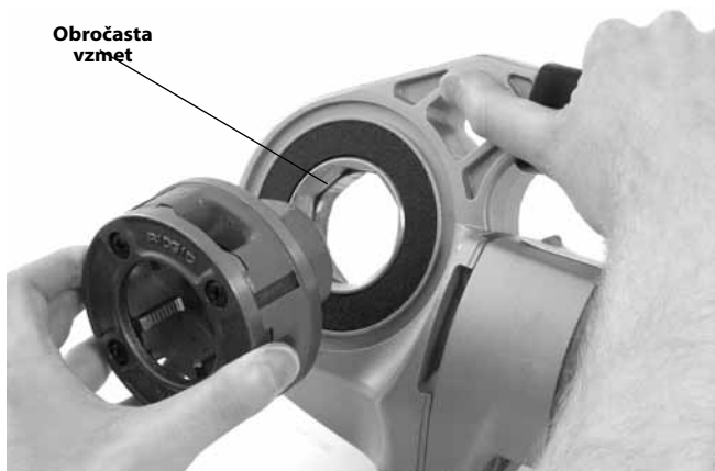
Slika 9 – Vgradnja rezalnih glav v električni pogon 600-I
