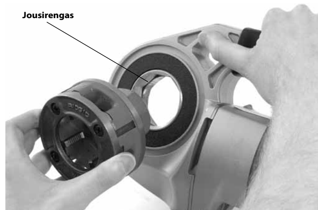
Kuva 9 – Kierrepäiden asennus 600-I-käyttölaitteeseen
