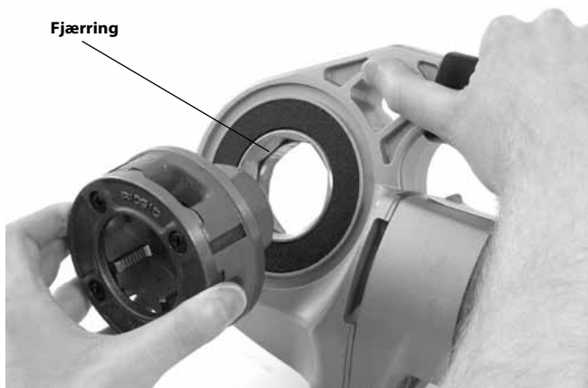
Figur 9 – installere gjengeskjærehoder i 600-I håndgjengemaskin
