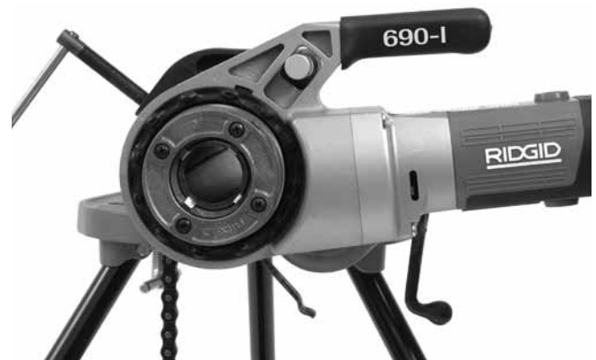
Abbildung 12 - Richtige Ausrichtung der Gewindeschneidmaschine
