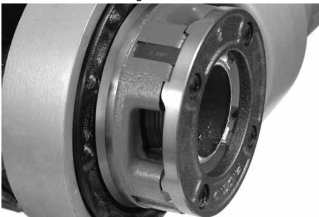
Figur 15 – Röret i linje med gängbackarnas kant
