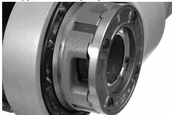
Rys. 15 – Rura równa z krawędzią noży
