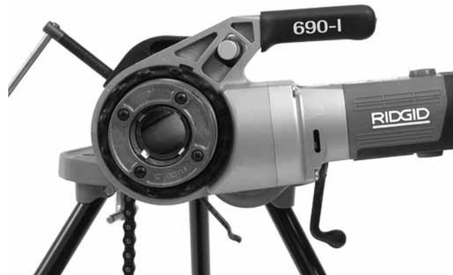
Şekil 12 - Elektrikli El Paftasının Doğru Yönü
