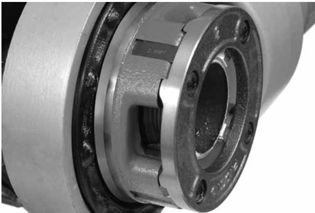
Figura 15 – Țeava la nivel cu marginea filierelor
