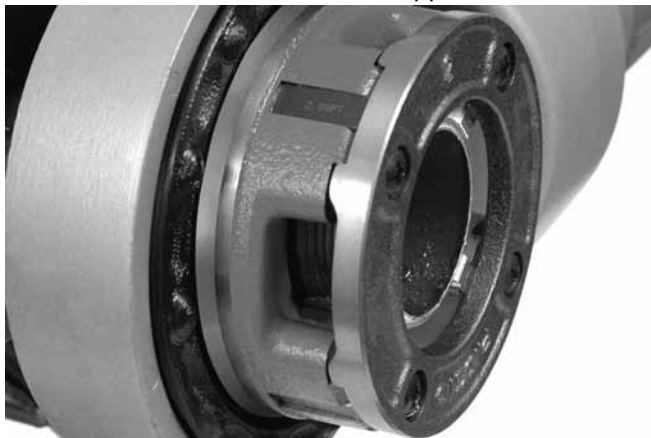
Figur 15 – Rør i niveau med skærkant på bakker
