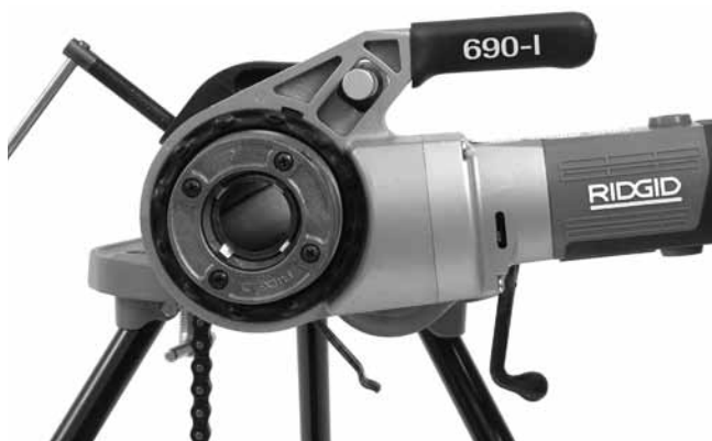
Figura 12 – Posizionamento corretto della Filettrice
