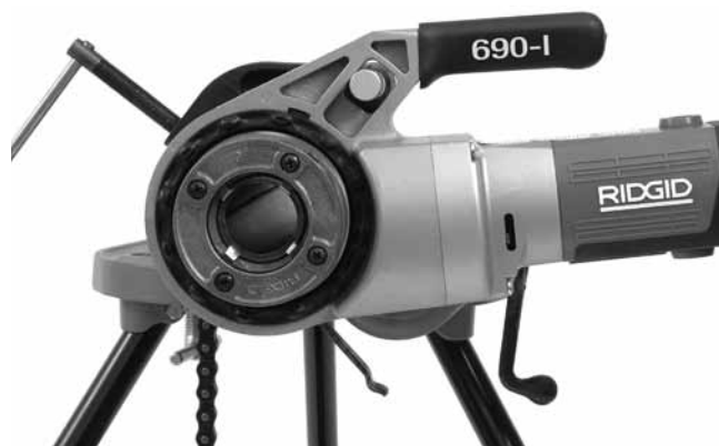
Figur 12 – Drivenhetens korrekta orientering
