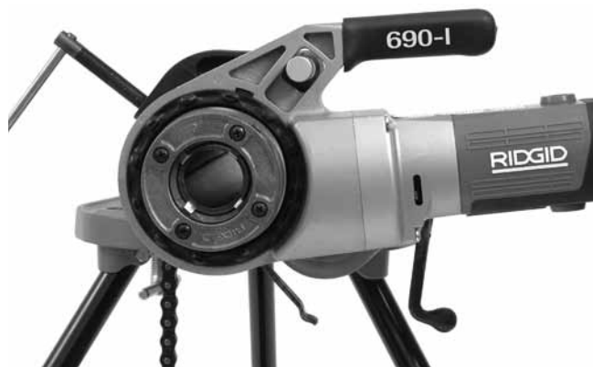
Figuur 12 – Correcte stand van de aandrijfmachine
