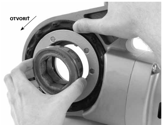
Obrázok 8 – Inštalácia adaptéra do 690-I
