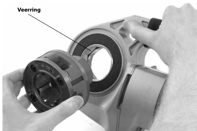
Figuur 9 – De draadsnijdkoppen in de aandrijfmachine 600-I installeren
