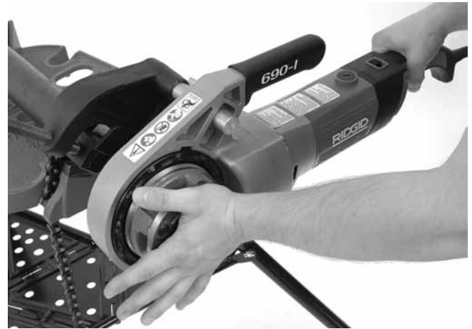
Figur 13 – Påbegyndelse af gevindskæringen
