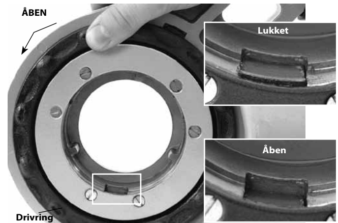
Figur 7 – Holdemekanisme, drivring i åben/lukket stilling
