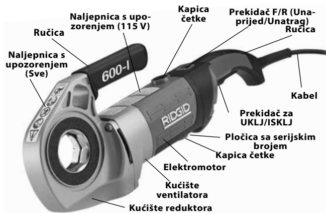
Slika 1 – Alat model 600-I
