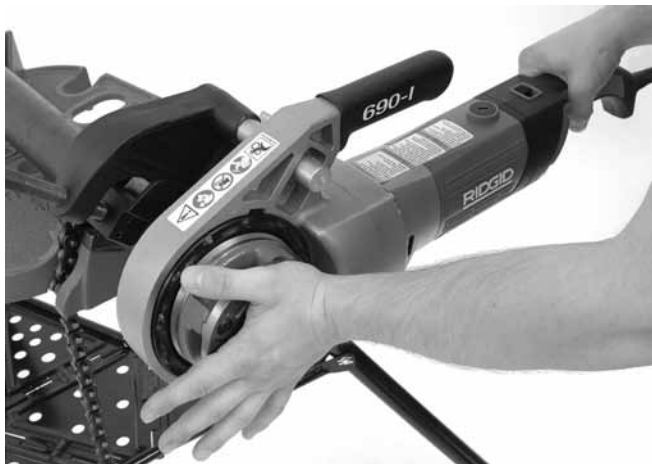
13. ábra – A menet megkezdése
