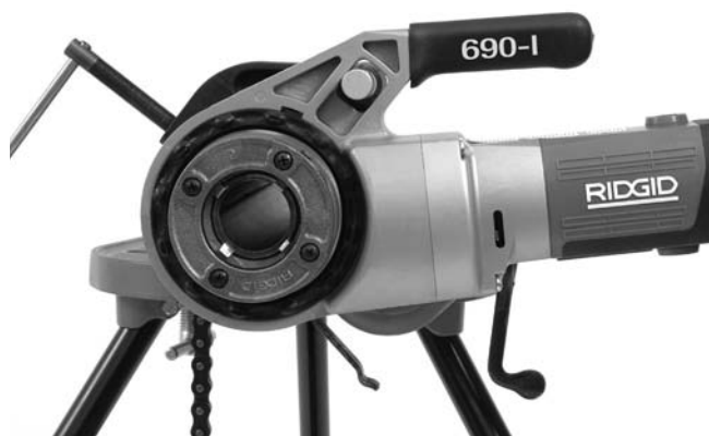
Figura 12 – Orientación correcta del accionamiento motorizado
