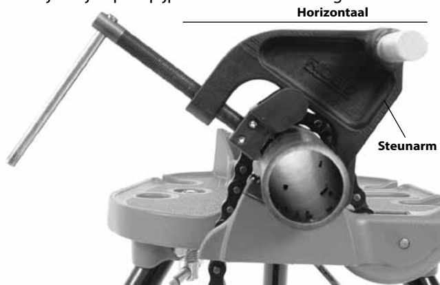
Figuur 11A – Aanbrengen van de steunarm
