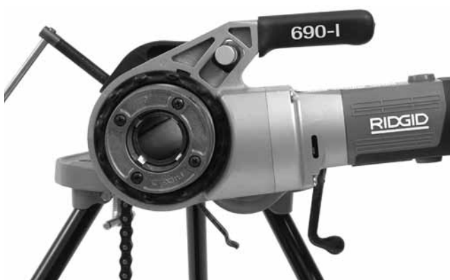
Rys. 12 – Prawidłowa orientacja napędu elektrycznego
