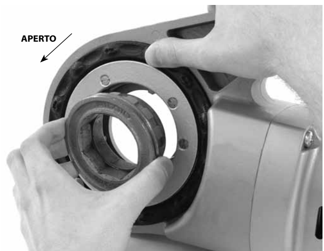
Figura 8 – Installazione dell'Adattatore nel 690-I
