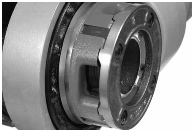
Figura 15 – Tubo allineato rispetto al margine dei pettini
