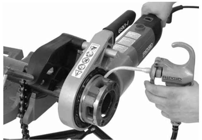
Şekil 14 - Boruya Diş Açılması
