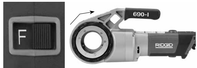
Rys. 6A – Położenie przełącznika F (DO PRZODU) (obroty w prawo)
