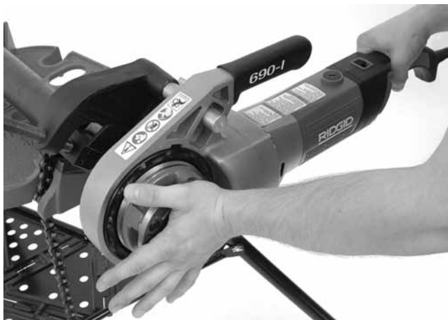
Рис. 13 – Начало нарезания резьбы
