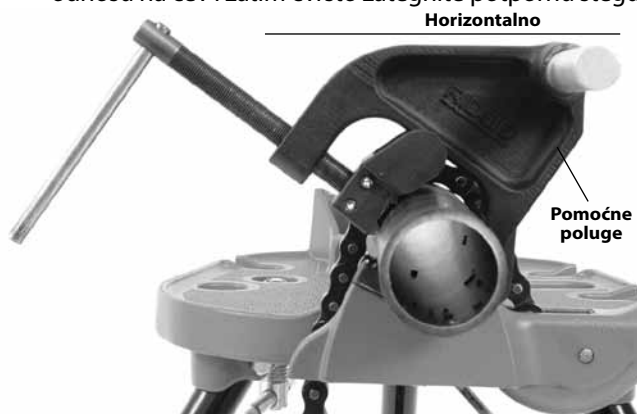
Slika 11A – Postavljanje potporne stega
