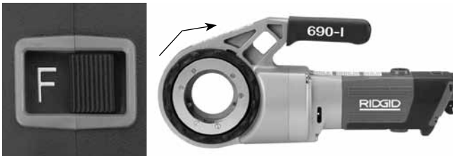
Kuva 6A – Kytkimen asento F (ETEENPÄIN) (myötäpäivään)
