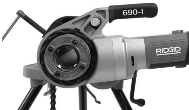
Figure 12 – Orientation appropriée du système d'entraînement
