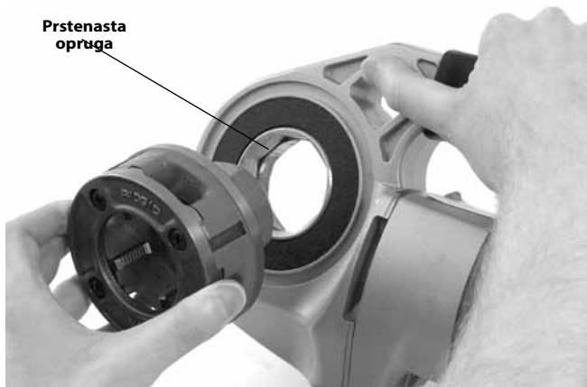
Slika 9 – Postavljanje narezni glava u alat 600-I
