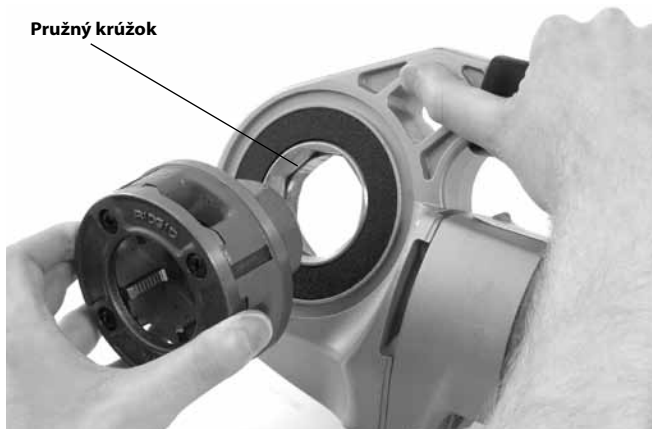
Obrázok 9 – Inštalácia závitorezných hláv do elektrického pohonu 600-I
