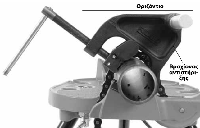
Εικόνα 11A – Τοποθέτηση του βραχίονα αντιστήριξης
