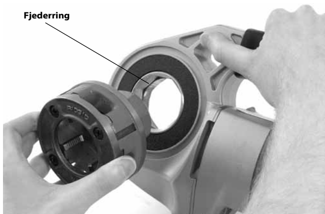
Figur 9 – Montage af gevindskærehoveder i det elektriske rørdrev 600-I
