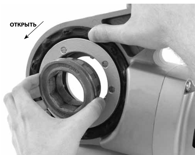
Рис. 8 – Установка переходника в силовой привод 690-I
