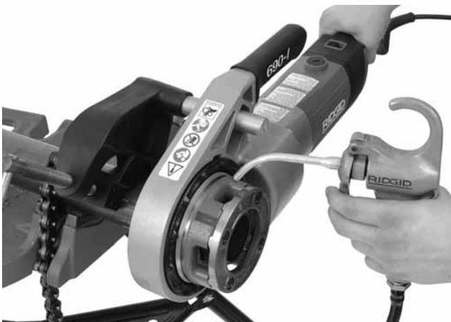
Figura 14 – Filettatura del tubo
