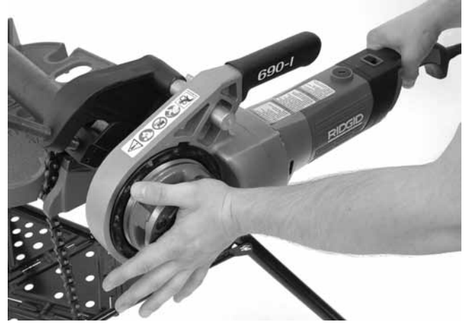
Şekil 13 - Diş Açmaya Başlama
