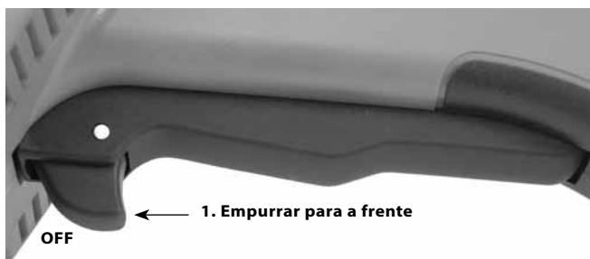
Figura 5A – Interruptor de Contacto Momentâneo de Dois Passos ON/OFF
