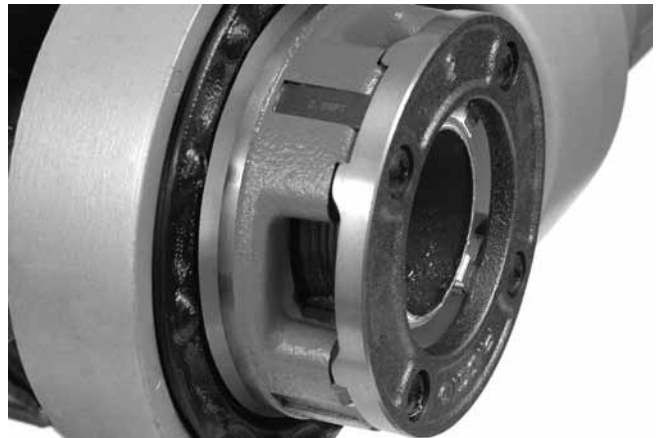
Figuur 15 – Pijp gelijk met rand van snijkussens
