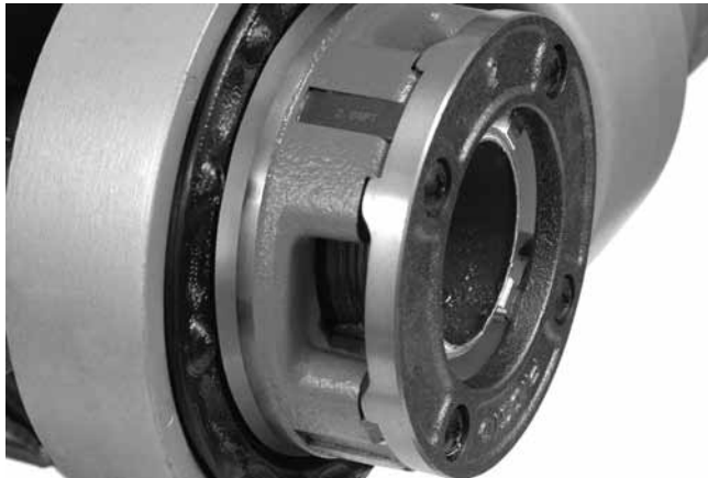
Figura 15 – Tubo Alinhado com Extremidade das Tarraxas
