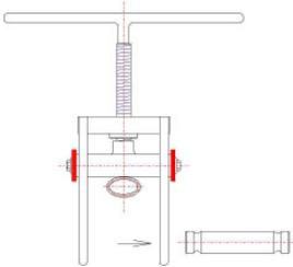
Die Quetschung wird gelöst, indem die Spindel wieder nach oben gedreht wird, bis die untere Achse herausnehmbar ist.
