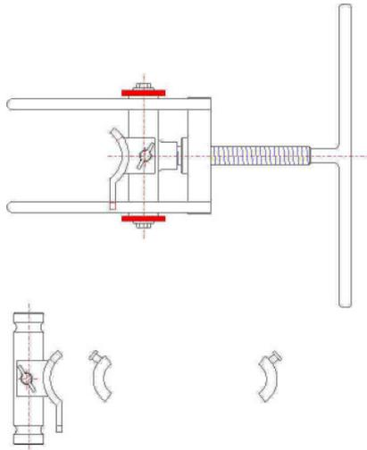
Erste Halbschale des PE Rückformer RF 63, mit dem Führungssteg nach unten, auf die obere Rolle der Quetschvorrichtung montieren.
