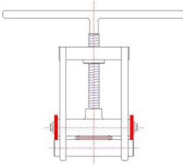
Spindel nach unten drehen, bis der Liniendruck des gequetschten Rohres spürbar Widerstand zeigt.
