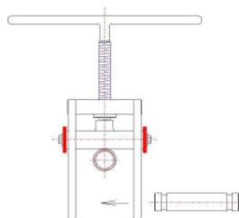
Die Rohrquetschvorrichtung mittig auf das PE-Rohr setzen.
