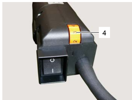
Drehzahl regeln bei BRB 4 Elektro
