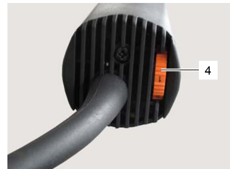
Drehzahl regeln bei BRB 2 Elektro
