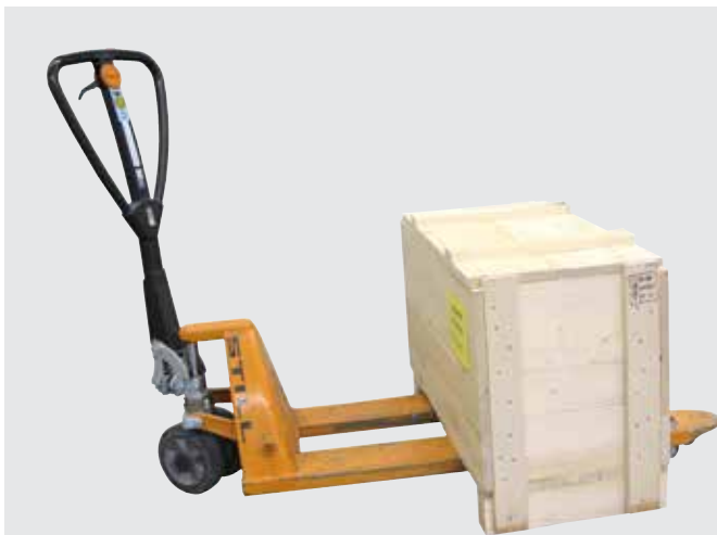
Transport in verpacktem Zustand in der Transportkiste oder auf einer Palette mit entsprechendem Hebemittel (z.B. Hubwagen).
