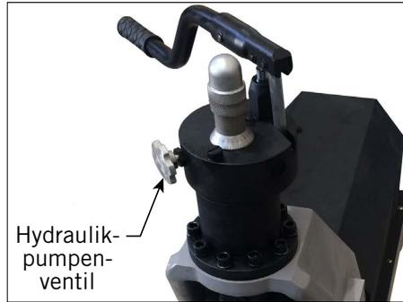
1. Drehen Sie den Knopf gegen den Uhrzeigersinn, um das Hydraulikpumpenventil zu öffnen.
