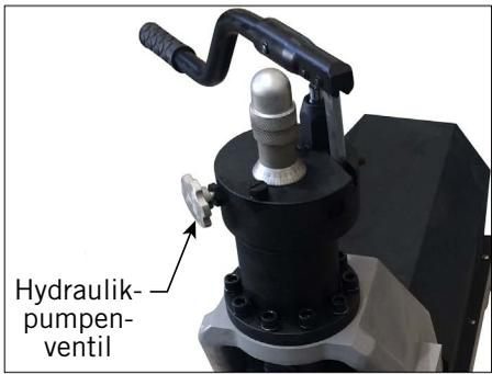
5. Drehen Sie den Knopf gegen den Uhrzeigersinn, um das Hydraulikpumpenventil zu öffnen. Dadurch werden die Schiebepatte und die obere Rolle auf ihre höchste Position angehoben.
