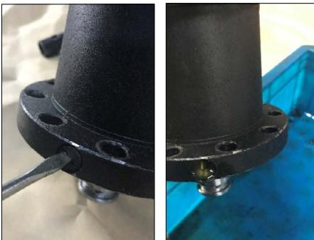
3. Entfernen Sie den Stopfen unten am Zylinder. Lassen Sie das Öl im Tank ab.
