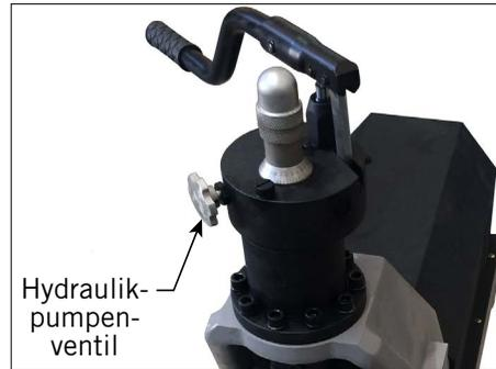
1. Drehen Sie den Knopf gegen den Uhrzeigersinn, um das Hydraulikpumpenventil zu öffnen. Dadurch werden die Schiebepatte und die obere Rolle auf ihre höchste Position angehoben.
