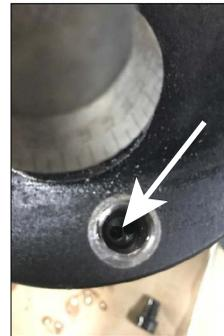
2. Lösen Sie das Ventil und legen Sie es zur Seite. Füllen Sie Öl ein, bis der Ölstand nahe an die Einlassöffnung kommt.
