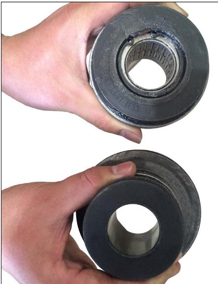
1. Vergewissern Sie sich, dass der richtige Rollensatz am Werkzeug angebracht ist. Die Rollen sind mit Rohrdurchmesser und Teilenummer gekennzeichnet. Wenn sich nicht die richtigen Rollen am Werkzeug befinden, muss der Rollensatz anhand der Schritte auf Seite 14 und 15 gewechselt werden.
