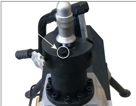
Öffnen Sie das Hydraulikpumpenventil, um den Druck im Hydrauliksystem abzulassen. Entfernen Sie dann den oben gezeigten Stopfen, um Hydraulikflüssigkeit nachzufüllen.
