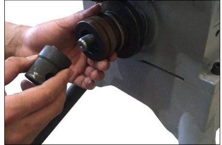
1. Schieben Sie die untere Rolle der gewünschten Größe vollständig auf die Hauptwelle. Dabei muss die markierte Seite nach außen zeigen.
