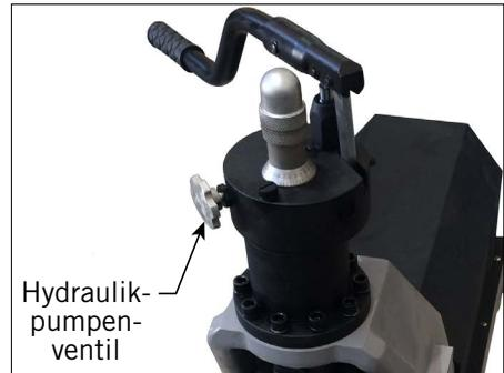
14. Um das Rohr freizugeben, öffnen Sie das Hydraulikpumpenventil durch Drehen des Knopfs gegen den Uhrzeigersinn (seien Sie darauf vorbereitet, kurze Rohrstücke abzustützen, wenn das Hydraulikpumpenventil geöffnet wird). Nehmen Sie das Rohr vom Werkzeug ab.
