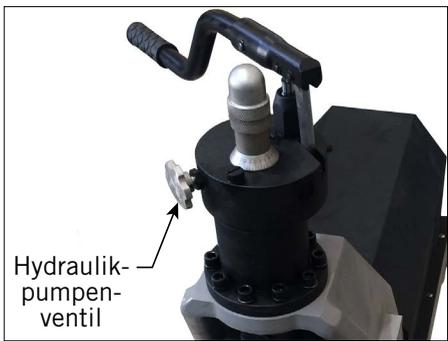
7. Drehen Sie den Knopf im Uhrzeigersinn, um das Hydraulikpumpenventil zu schließen.
