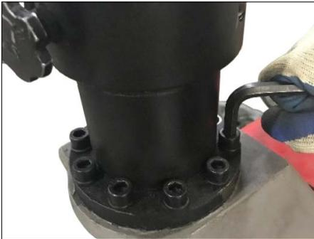
2. Entfernen Sie die Schrauben, mit denen der Zylinder befestigt ist.
