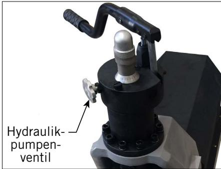
1. Drehen Sie den Knopf gegen den Uhrzeigersinn, um das Hydraulikpumpenventil zu öffnen.
