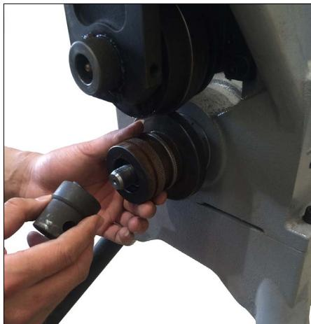
2. Entfernen Sie die Befestigungsschraube der Hauptwelle und nehmen Sie dann die untere Rolle ab. Bewahren Sie die untere Rolle an einem sicheren Ort auf.
