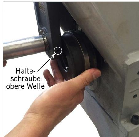
2. Lösen Sie die Halteschraube der oberen Welle.
