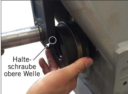
1. Setzen Sie die obere Rolle der gewünschten Größe vorsichtig hinter der Schiebeplatte/dem oberen Rollenhalter ein. Dabei müssen die Markierungen an der Rolle nach außen zeigen.
