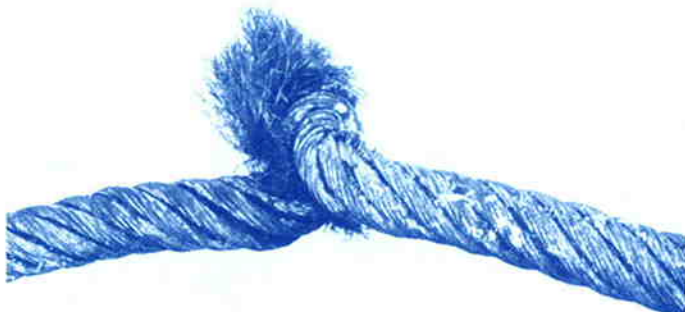
Bild 7 - Durch Zuziehen einer Seilschlinge entstandene Klanke
