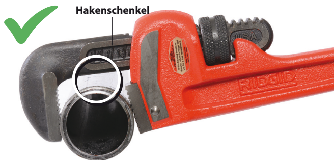
Abbildung 3 – Spalt zwischen Hakenschenkel und Werkstück lassen
