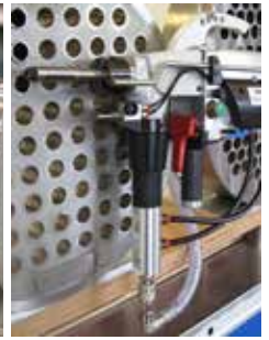
Integrierte Balancervorrichtung für ein sicheres, entspanntes und ermüdungsfreies Arbeiten
