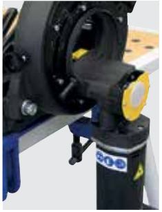
Inklusive zweite Sägeblattaufnahme zum Heraustrennen von Rohrbögen
