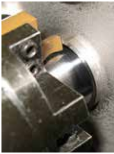
Exaktes Planen und Anfasen durch Einsatz von bis zu vier besonders preisgünstigen Tool Bits (optional erhältlich)
