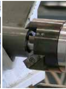
Normgerechte, präzise und reproduzierbare Schweißnahtvorbereitung
