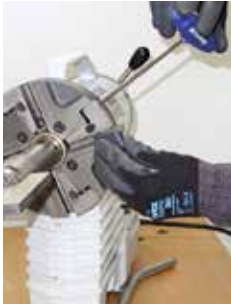
Werkzeug-Schnellspannsystem QTC® (Quick-Tool-Change)
