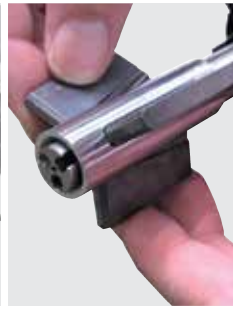
Das Spannsystem "NC" ist mit seinen im Mast fest verankerten Spannkeilen unverlierbar
