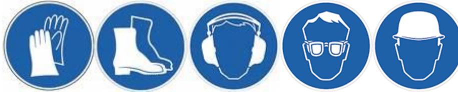
8. **TRAGEN SIE EINE GEEIGNETE KLEIDUNG.** Tragen Sie nie weite Kleidung, Krawatte, Ringe, Armbänder oder anderen Schmuck. Er könnte sich in sich drehenden Teilen verfangen oder einklemmen. Tragen Sie immer Sicherheitsschuhe mit einer rutschfesten Sohle und Stahlkappen. Tragen Sie einen Helm, der insbesondere lange Haare abdeckt und den Kopf schützt.
