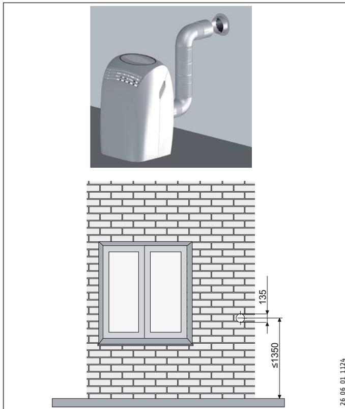
Der Luftstrom darf nicht durch Schutzgitter oder Ähnliches behindert werden. Eventuelle Schutzgitter müssen einen freien Querschnitt für den Luftstrom von mindestens  $140 \text{ cm}^2$  aufweisen.
