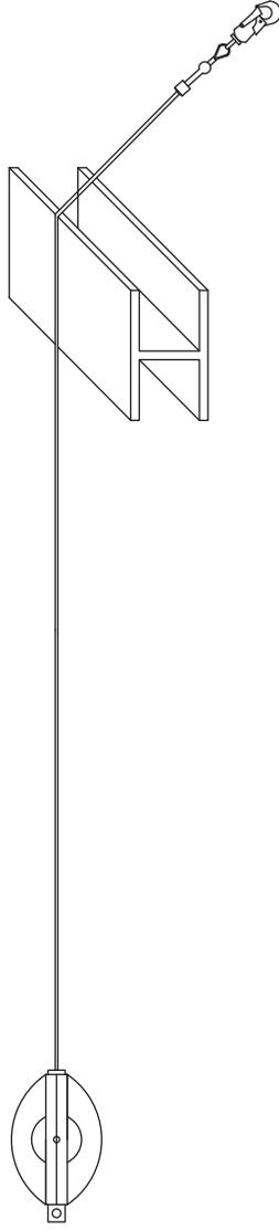
**FR :** Ne pas utiliser sur un angle de structure métallique en position horizontale
