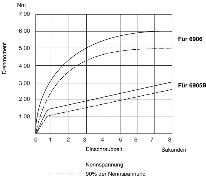
Halten Sie die Maschine fest und setzen Sie den Steckschlüsseleinsatz auf die Schraube oder Mutter. Ziehen Sie unter Berücksichtigung der Einschraubzeit die Schraubverbindung an.
