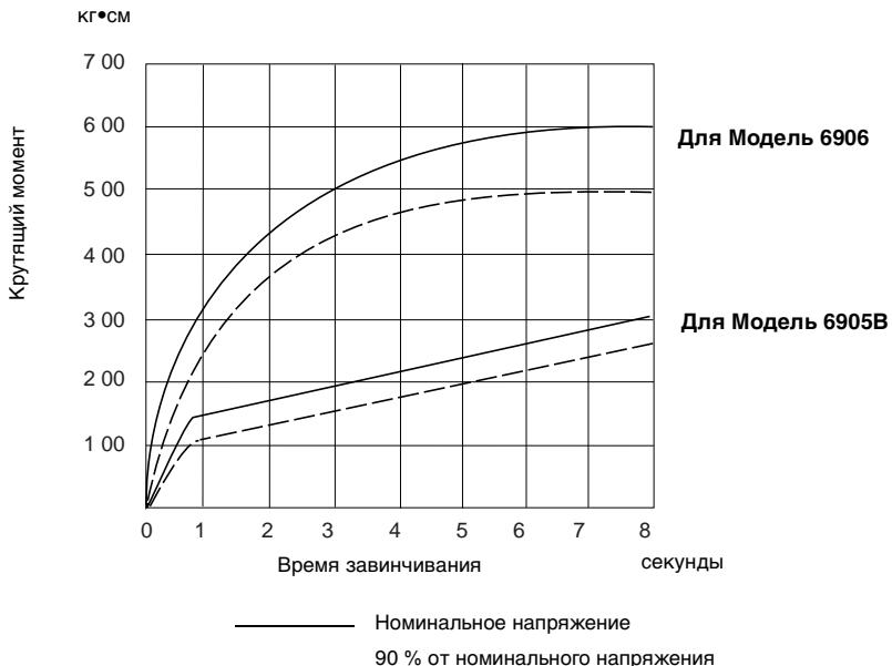
Держите инструмент крепко и поместите гнездо сверху болту или гайке. Включите инструмент и завинчивайте в течение правильного времени завинчивания.
