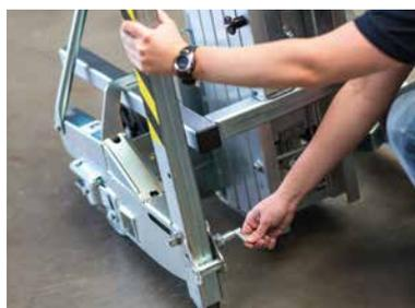
Öffnen und Fixieren der Vorderteile mittels Federriegel
