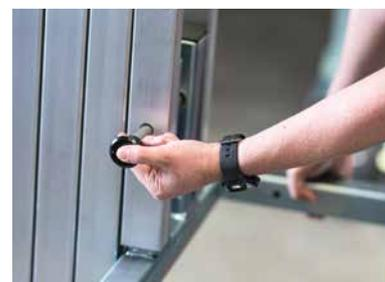
Montage und Fixierung der Lastgabel mittels Kugelsperrbolzen
