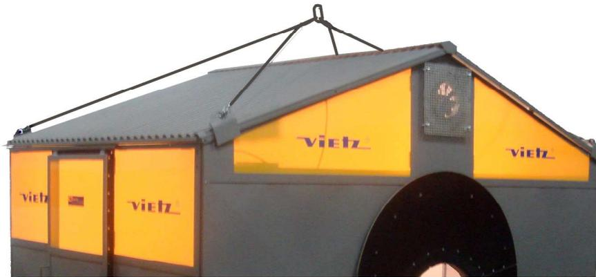
NACH DER DACHBEFESTIGUNG WIRD DER HUBSEILSATZ ANGEBRACHT. MÖGLICHKEIT: SEILE IN KRAN EINHÄNGEN, UND 4 SEILENDEN AUSEINANDER ZIEHEN:
