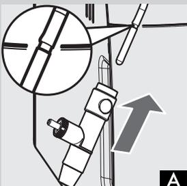
**21** Den Cappuccinatore einstecken, bis das Einrasten in der Aufnahme in der Dampfdüse, die in Abb. A gezeigt wird, zu hören ist.
