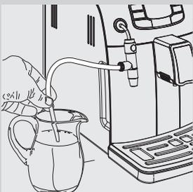
9 Den Ansaugschlauch in den Behälter einstecken.
