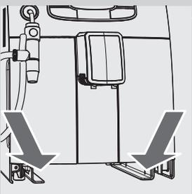
**1** Die Aufnahme der Abtropfschale reinigen.
