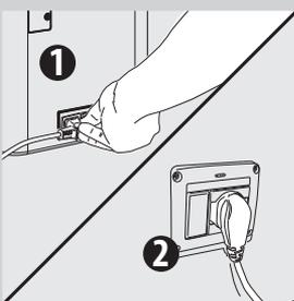
10 Den Stecker in die Steckdose auf der Rückseite der Maschine einstecken.
