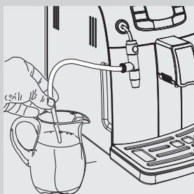
**3** Den Ansaugschlauch in den Behälter einstecken.
