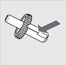
**19** Sicherstellen, dass alle Milchrückstände aus der Nut des Anschlusses entfernt werden (siehe Pfeil in der Abbildung links). Im gegenteiligen Falle kann die Milch nicht aufgeschäumt werden. Mit einem feuchten scheuernden Tuch gründlich reinigen.
