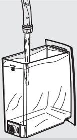
**17** Wenn der Wassertank leer ist, diesen herausnehmen, ausspülen und bis zum Füllstand MAX mit frischem Wasser füllen. Wieder in die Maschine einsetzen.
