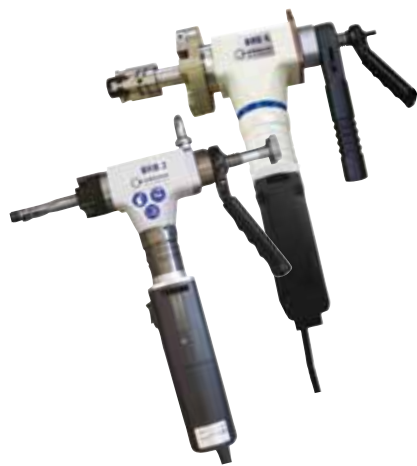
BRB 2 und BRB 4 Elektro mit Spannsystem "Standard"
