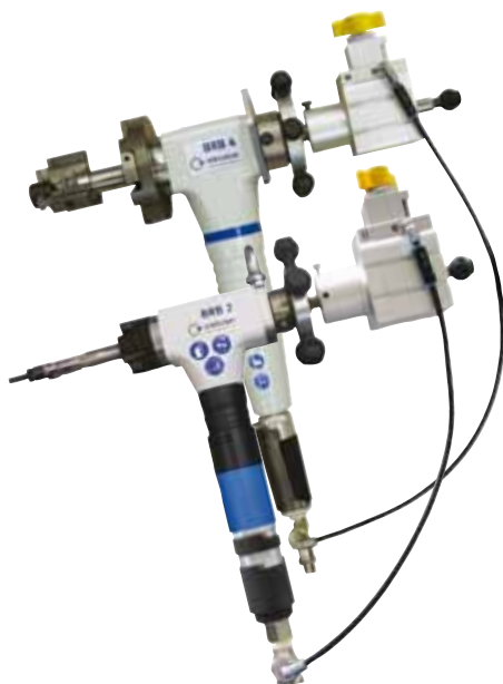
BRB 2 und BRB 4 Druckluft/Auto mit Spannsystem "Standard"
