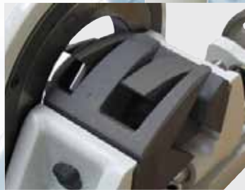
Deformationsfreies Spannen durch integrierte Wende- Spannbacken
