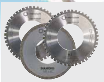
Inklusive TCT-Sägeblatt für Stahl, Kupfer, Aluminium und alle Kunststoffarten. DIAMANT-Trennblatt für Guss-eisen und CERMET-Sägeblatt für Edelstahl als Zubehör erhältlich.
