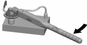
Sollte dabei ein Klick-Geräusch zu hören und ein leichtes Rucken zu spüren sein, SOFORT das Drehmoment-Schraubwerkzeug entlasten. Die Verschraubung kann mit dem eingesetzten Drehmoment-Schraubwerkzeug nicht beendet werden, da das max. Drehmoment des Drehmoment-Schraubwerkzeuges überschritten ist.
