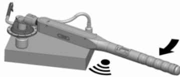
Stellen Sie nun das Drehmoment-Schraubwerkzeug auf sein max. zulässiges Drehmoment ein. Stellen Sie die Gradscheibe auf den gewünschten Winkel ein.
