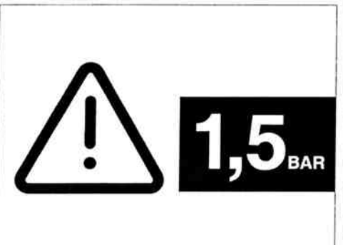
Achtung: Angegebenen Reifendruck beibehalten! Siehe Kapitel 1 „Vorwort“, Abschnitt „Technische Daten“
