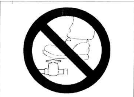
Nicht auf Wartungsventil oder andere/n Drucksystemteile stellen/stehten.
