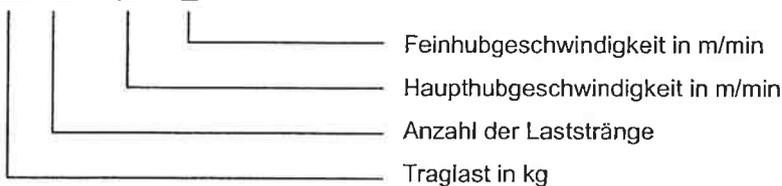
Die technischen Daten sind entsprechend der Maschinenrichtlinie 98/37 EG in den zum Elektrokettenzug beigefügten Dokumentationen enthalten.
