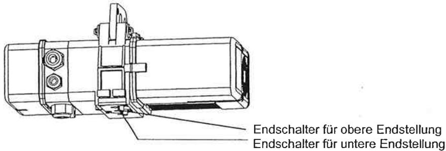
Bild 18: zusätzliche elektrische Endschalter bei 24 V Kleinspannung
