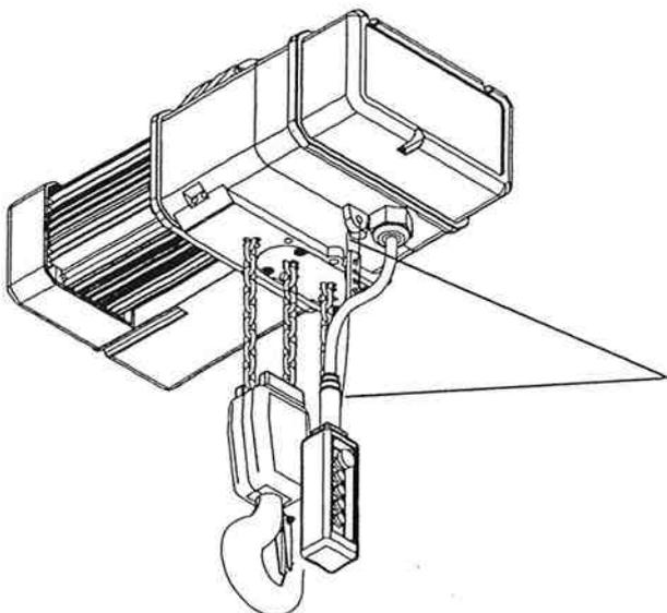
Die Zugentlastung ist so zu befestigen, dass keine Zugkräfte auf die Steuerleitung wirken. Das Ziehen des Kettenzuges am Steuerschalter mittels der Zugentlastung ist nicht zulässig.
