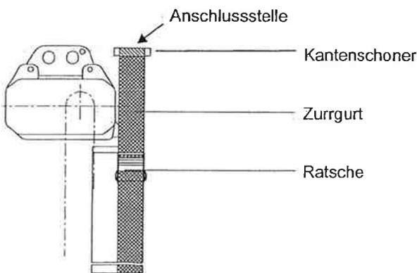
Bild 10: Stationärer Elektrokettenzug mit Kettenspeicher (mit am Einsatzort zu schaffender Anschlussstelle)
