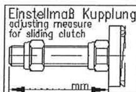
Bild 27: Einstellung des Reibmomentes an der Rutschkupplung
