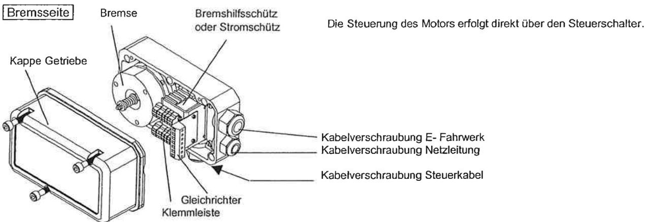
Bild 16: Direktsteuerung
