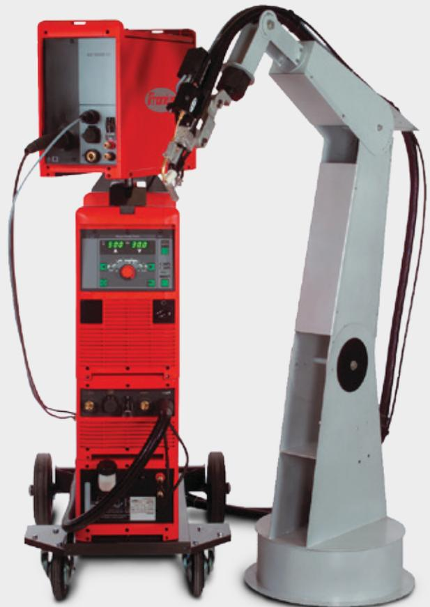
/ MagicWave 5000 und Roboterschweißbrenner Robacta TTW 4500 mit Kaltdraht-Fördereinheit Robacta KD-Drive
