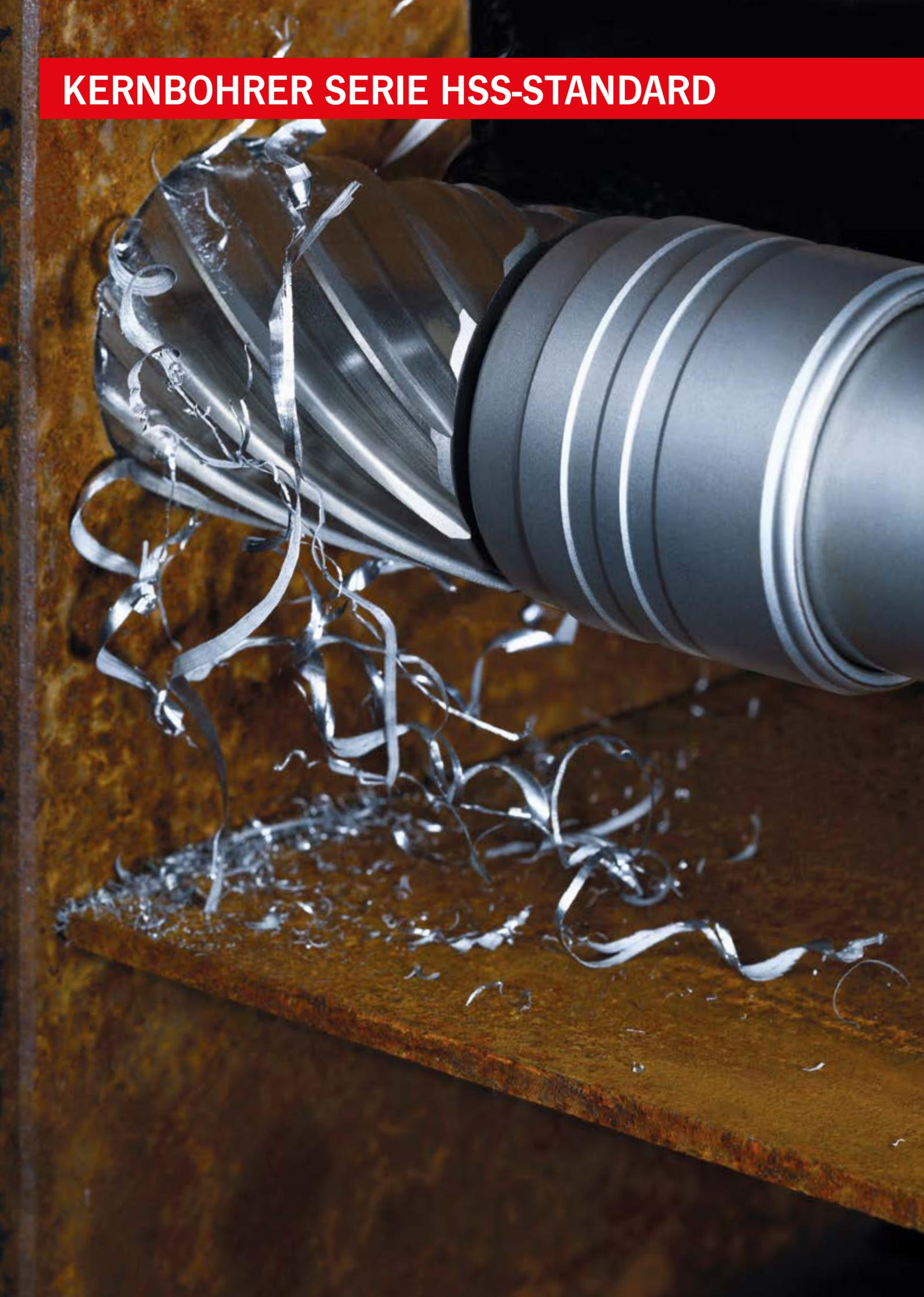
Das Kernbohrer-Basissortiment für den professionellen Einsatz. Vollschliff-Kernbohrer aus Hochleistungsschnellstahl auf CNC-gesteuerten Schleifzentren gefertigt, mit guter Spanableitung, Bohren mit geringem Kraftaufwand. Für horizontale Arbeiten empfiehlt BDS Hochleistungsfettspray BDS 5200.
