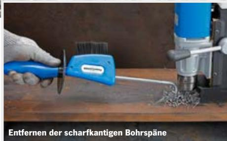
Entfernen der scharfkantigen Bohrspäne
