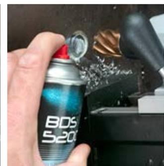
Schritt 2: Während des Bohrens Hochleistungs-fettspray auf die Bohrspitze und in die Bohrung sprühen.
