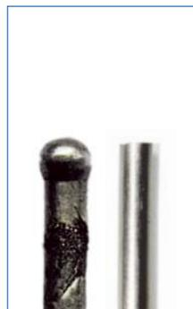
Planschliff nach einer mit Schweißgut behafteten Elektrode (Multifunktionsabdeckung)
