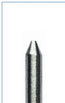
Schleifen einer Kegelform mit der Öffnung in der Multifunktionsabdeckung
