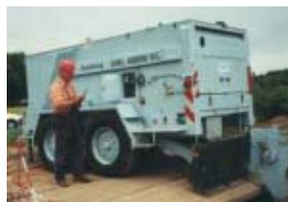
Die Winde ist auf einem Stahlchassis montiert und je nach Ausführung mit einem gefederten Einachs- oder Tandemfahrgestell, mit starrer oder höhenverstellbarer Zugdeichsel, Auflaufbremse und Rückfahrautomatik ausgerüstet. Winden mit einem Gesamtgewicht über 3500 kg sind mit einer Zweileitungs-Druckluftbremse ausgestattet
