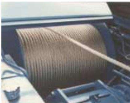
Unabhängig von der jeweiligen Zugkraft wird das Seil auf die Speichertrommel aufgewickelt, der Antrieb erfolgt über einen separaten Hydraulikmotor. Für eine gleichmäßige Verteilung des Seils auf die Trommel sorgt ein automatischer Aufspulmechanismus. Beim Aufspulen wird das Seil mit nur etwa 3% der anstehenden Zugkraft gewickelt, eine mechanische Beanspruchung des Seils durch den Aufspulvorgang wird dadurch weitgehend vermieden.
