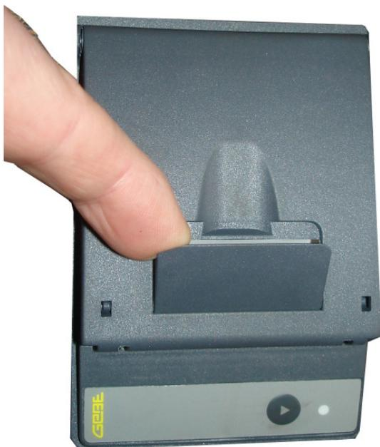
Zum Auswechseln der Papierrolle wird die obere Abdeckung geöffnet.
