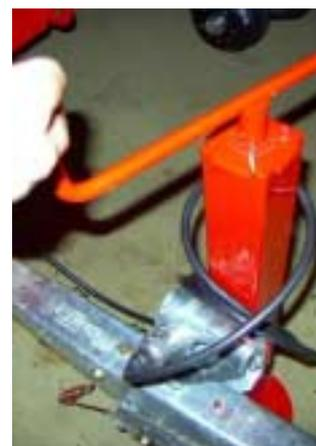
Die Vorsteckbolzen durch die Stützträger und Stützen stecken und die Winde an der Stützwinde soweit hochkurbeln bis sie fest verankert ist.
