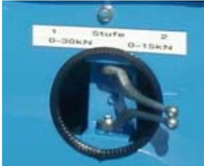
Die Winden verfügen über eine Stufen-schaltung die eine Geschwindigkeit Grundstufenvorwahl ermöglichen. Innerhalb einer Grundstufe lässt sich die Seilgeschwindigkeit von 0 bis maximal stufenlos verstellen, wobei die maximale Ziehgeschwindigkeit in Stufe 2 erreicht wird. Dabei muss berücksichtigt werden, dass in Stufe 2 nur mit der Hälfte der möglichen Zugkraft der Winde gearbeitet werden kann.
