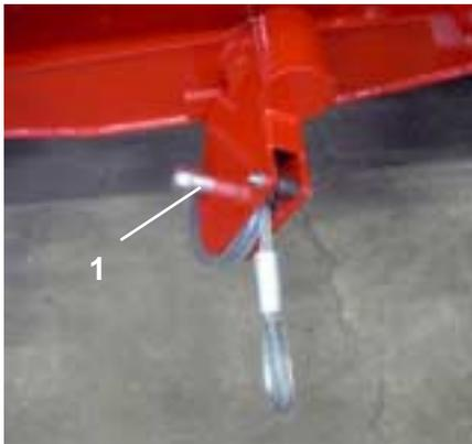
Einige Rohrsanierungsarbeiten erfordern den Einsatz eines Umlenkbaums der, gegen Aufpreis, als Zubehör zur Winde erhältlich ist. Die Arbeitstiefe kann am Umlenkbaum in verschiedenen Stufen eingestellt werden. Der Umlenkbaum wird, an die dafür vorgesehene Aufnahme **1** der Schwenkrolle befestigt und mit den entsprechenden Federsteckern gesichert.
