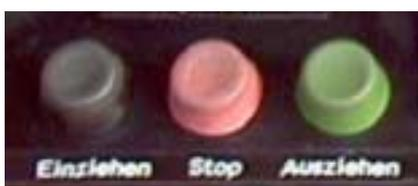
Auch für die Rohrsanierungswinde gilt: Je größer die au fgebrachten Zugkräfte desto niedriger muss die Seil geschwindigkeit eingestellt werden.
