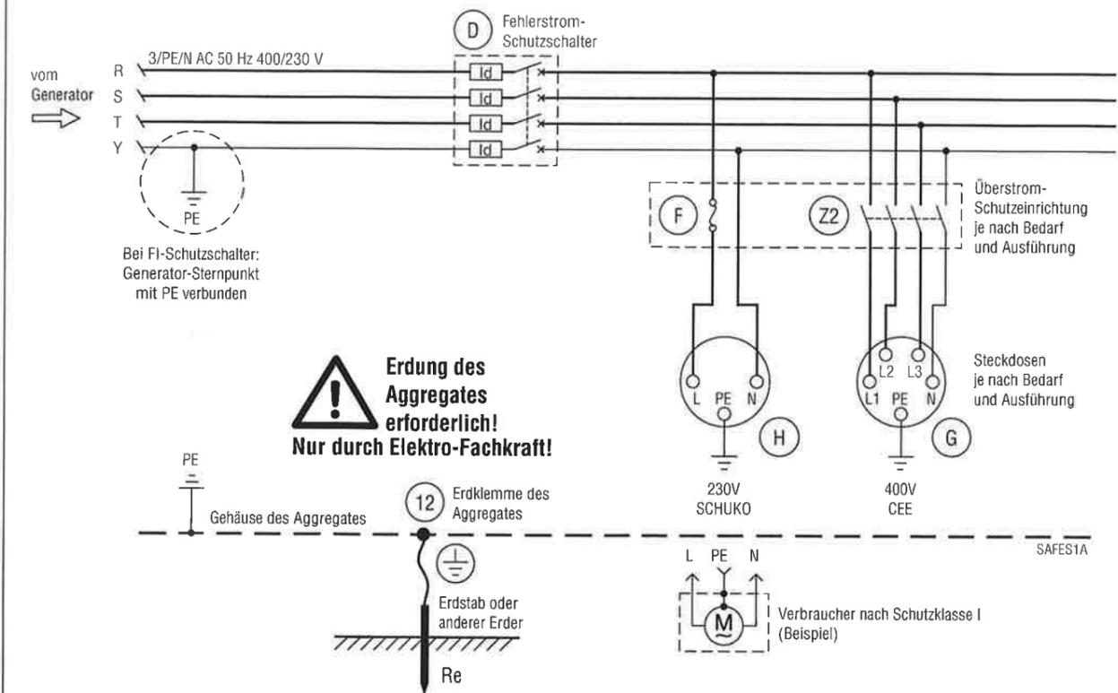
Schutz durch Schutztrennung mit Isolationsüberwachung und Abschaltung (Prinzip)
