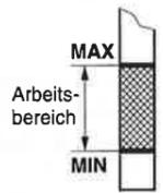
→ Sicherstellen: Motor ist aus, Aggregat steht waagrecht, Öl hat sich in der Ölwanne gesammelt (nach Motorlauf)
