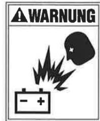
Beim Laden der Starterbatterie entstehen explosive Gase.
