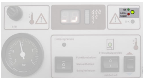
Bild: Bedienfeld LED-Kontroll-Anzeige „Kesselentlüftung“
