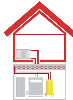
Voll funktionsfähige mobile Heizzentrale inkl. MAG, Pumpe, Temperaturregelung und sicherheitstechnischer Einrichtungen. **Mit Aufheizprogrammen nach DIN EN 1264-4.**
