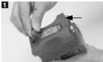
**Einbau und Wechsel der Schlagtypen:** Einsetzen der Schlagtypen gemäss der gewünschten Markierung. Verriegelungshebel in entriegelter Stellung.
