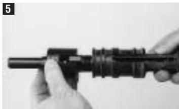
Standplatte 75/10-G bis zum Anschlag auf die Kolbenführung aufschrauben und bis zum Einrasten zurückdrehen.
