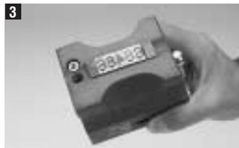
Die Schlagtypen immer in die Mitte des Markierkopfes 75/CM/HM setzen, in dem eine gleiche Anzahl von Leer-Schlagtypen beiderseits des eingesetzten Markierungszuges angebracht wird.
