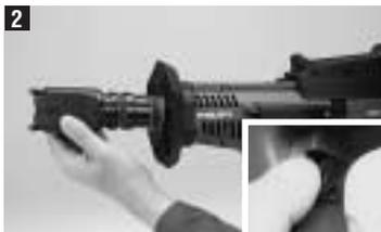
Hebel (17) nach rechts drehen und Kolbenführung herausziehen.
