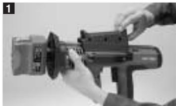
1 Zerlegen des Gerätes z. B. zum Erneuern des Kolbens oder zum Reinigen: Riegel anheben und Repetiergriff nach hinten schieben.
