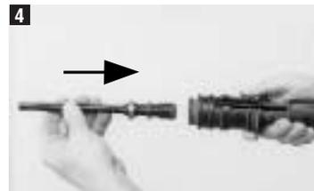
Gitterrost-Kolben (75/10-G) einsetzen; **Stoppring nicht vergessen.**
