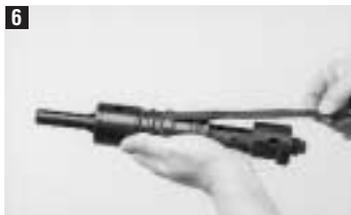
Schieber in Nut einsetzen.
