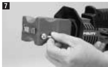
Nach dem Einlegen der gewünschten Schlagtypen müssen diese durch Drehung des Verriegelungshebels gesichert werden.
