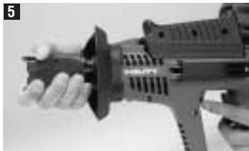
Arretierung Hebel (17) nach links drehen bis er einrastet.
