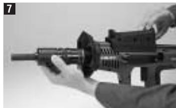
Kompletten Einsatz mit obenliegendem Schieber und angehobenem Riegel in den Gerätekörper einsetzen, Standplatte bis zum Anschlag zurückschieben und Hebel (17) nach links drehen.
