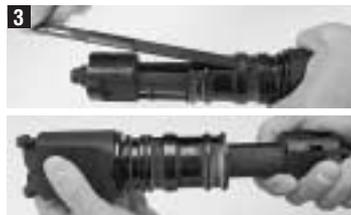
Schieber entfernen, Standplatte oder Elementmagazin abschrauben und den Kolben aus der Kolbenführung ziehen.
