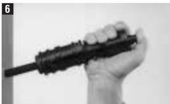
Wenn der Stoppring auf dem Kolben klemmt, Kolbenführung mit Kolben auf einen festen Untergrund schlagen bis sich der Stoppring löst.
