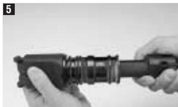
Hohe Überenergie (z. B. durch Setzen neben die Pfette) wird vom Gerät über den Stoppring aufgenommen. Ist der Stoppring deformiert, muss er erneuert werden. Kolbenführung (9) wie beschrieben ausbauen. Standplatte (1) oder Elementemagazin abschrauben.
