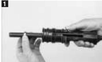
Kolben (5) und Stoppring (8) in die Kolbenführung (9) einsetzen.
