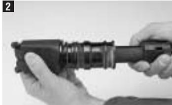
Standplatte (1) oder Elementemagazin bis zum Anschlag auf die Kolbenführung (9) aufschrauben und bis zum Einrasten zurückdrehen.
