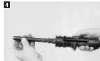
4 Hartmarkierkolben (75/H in die Kolbenführung einsetzen (**keinen Stopping verwenden**).
