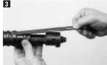
Schieber (13) in Nut einsetzen.
