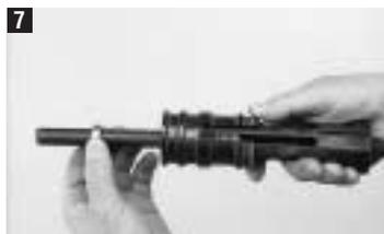
Alten Stoppring (8) entfernen, neuen Stoppring (8) auf den Kolben (5) schieben.
