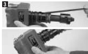
3 Schieber entfernen. Markierkopf abschrauben und den Kolben aus der Kolbenführung ziehen.
