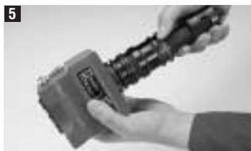
5 Markierkopf 75/CM/HM bis zum Anschlag auf die Kolbenführung aufschrauben und in die gewünschte Stellung zurückdrehen.
