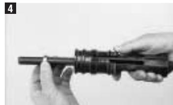
Neuen Kolben einsetzen: Stoppring (8) nicht vergessen. Standplatte bzw. Elementemagazin wieder aufschrauben.
