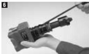
6 Schieber in Nut einsetzen.
