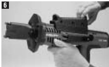
Repetiergriff (2) mit aufgehobenem Riegel (14) ganz nach vorne schieben, Riegel loslassen und einmal repetieren.
