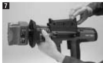
7 Kompletten Einsatz mit obenliegendem Schieber und angehobenem Riegel in den Gerätekörper einsetzen. Standplatte bis zum Anschlag zurückschieben und Hebel (17) nach links drehen.
