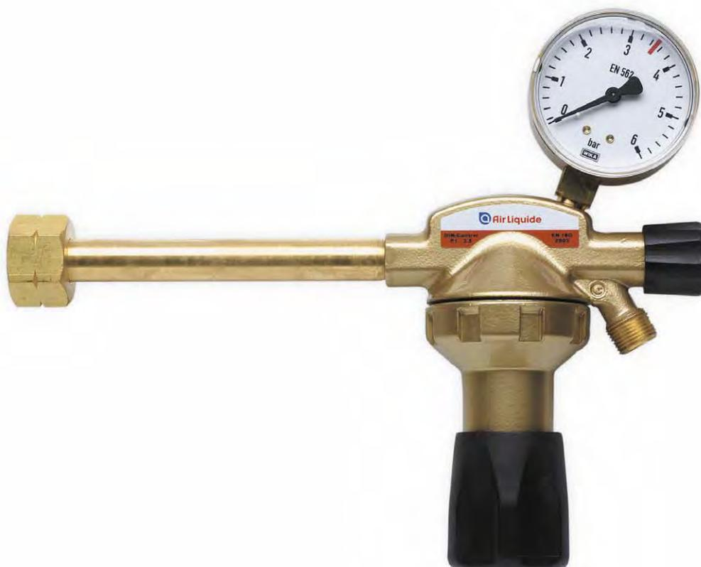
Dieser Druckminderer eignet sich für Propan, Butan und deren Gemische. Er reduziert auf 0–4 bar Arbeitsdruck und fördert bis zu 10 kg/h. Der Arbeitsdruck ist am Manometer ablesbar.
