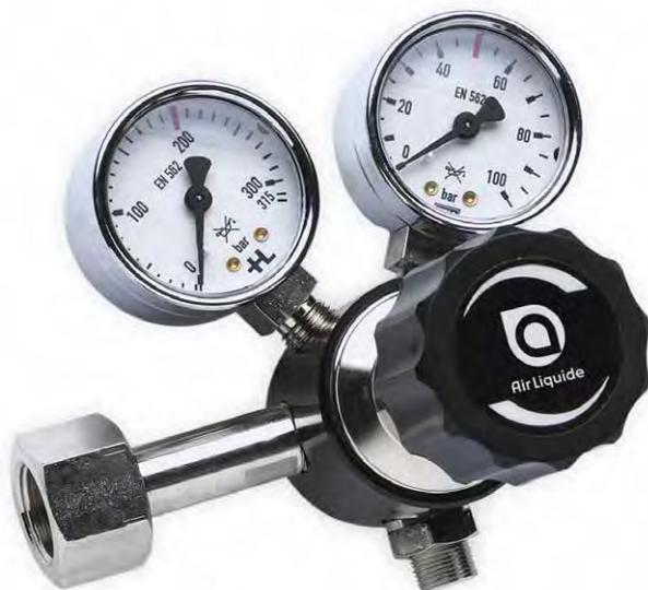
Der HL-HD 50 ist ein Druckminderer für höheren Arbeitsdruck bis 50 bar. Er leistet bei einem Eingangsdruck von 200 bar und z. B. einem gewünschten Arbeitsdruck von 40 bar zirka 60 m<sup>3</sup>/h bei Wasserstoff, 45 m<sup>3</sup>/h bei Helium und 15 m<sup>3</sup>/h bei den übrigen Gasen.
