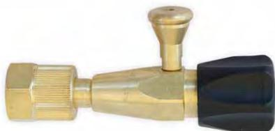
Dieses Ventil hat einen speziell geformten Wulst zur Ballonaufnahme. Der Ballon hält während der Aufblasphase ohne Zuhilfenahme der Hände am Ventil. Ein Einschalthebel mit Öffnungsbegrenzung ermöglicht ein fein dosierbares Aufblasen. Leichte Montage und Demontage durch den Handanschluss W 21,8 x 1/14 an das Flaschenventil. Es wird kein Schlüssel benötigt.
