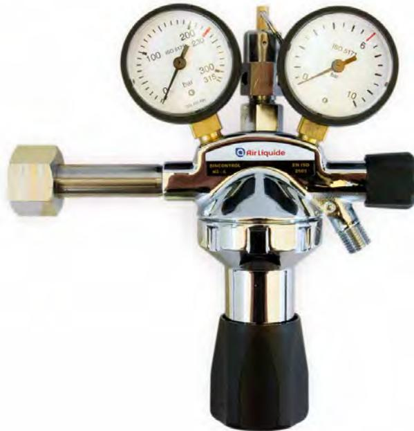
Die Flaschendruckminderer für Getränkeschankanlagen für die Gase Stickstoff und Kohlendioxid reduzieren den Flaschendruck (Vordruck) auf den gewünschten Arbeitsdruck (Hinterdruck) zwischen 0 und 6 bar. Ein plombiertes Sicherheitsventil verhindert einen ungewollten, übermäßigen Arbeitsdruck über 7 bar und schützt dadurch sicher und zuverlässig die Schankanlage.
