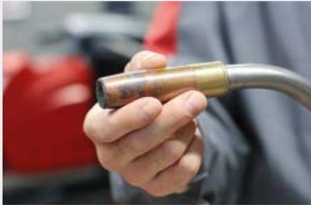
/ Völlig neues Kühlkonzept bis in die Gasdüse des Brenners. Für kühles, präzises Arbeiten und längere Standzeiten der Verschleißteile.
