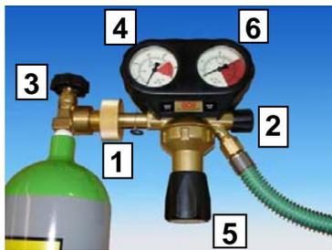
Druckminderer mit Knebelschraube ( 1 ) an der Druckluftflasche 200 oder 300 bar anschließen.
