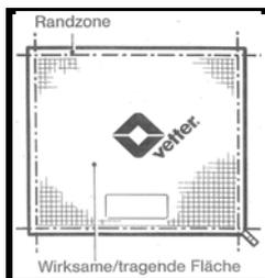
Zur Nutzung der maximalen Hubkraft muss die gesamte wirksame Fläche, d.h. Gesamtfläche abzgl. Randbereiche, vollflächig unter der zu hebenden Last und das Kissen muss mit dem max. zul. Betriebsdruck befüllt werden. **Die größte Hubkraft entwickelt das Hebekissen zu Beginn des Hubweges !**
