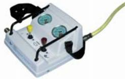
Füllschläuche an den Ausgangskupplungen auf der Rückseite des Steuerorganes anschließen. Luftzuführung an der seitlichen Eingangskupplung anschließen. Zum Befüllen der Mini-Hebekissen den Schalthebel nach vorne ziehen. Dabei die entsprechenden Manometer und die Lastbewegung beobachten.
