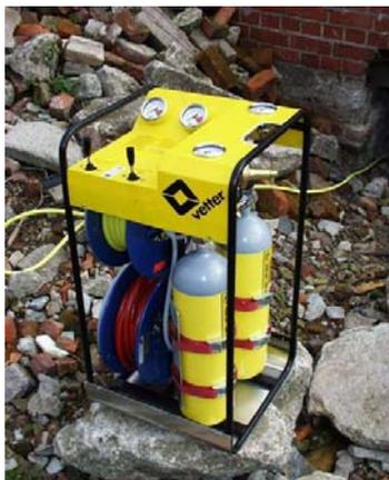
Die Schnellangriffseinheit SAG 8 stellt die kompakte und mobile Füll- und Betriebsstation für Mini-Hebekissen 8 bar dar.
