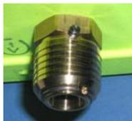
Luftzuführungsschlauch, bzw. Anschlusschlauch des Druckminderers mit dem Stecknippel der Eingangskupplung am Steuerorgan verbinden, dabei den Nippel fest in die Kupplung drücken, bis dieser spürbar einrastet. Zur zusätzlichen Sicherung die Messinghülse der Kupplung gegen den Sicherungsstift verdrehen.
