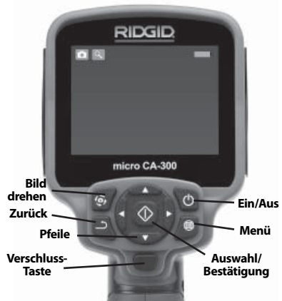
Abbildung 2 - Bedienelemente der Display-Einheit
