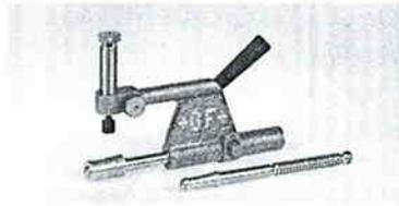
In das Grundgerät werden für jede Rohrdimension und Rohrwanddicke die erforderlichen Einsätze eingesetzt. Röhre vorher gut reinigen und rechtwinklig ablängen.
