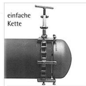
Zum Zentrieren und Spannen von Langrohren ohne Längenbegrenzung sowie von Rohrbögen, T-Stücken, Flanschen, Reduzier- und sonstigen Formstücken an Rohre und Behälter. Die flexiblen Außenzentrierketten passen um jedes Rohr und jeden Behälter. Sie lassen sich durch einfaches Auswechseln der Ergänzungsglieder beliebig verlängern oder verkürzen. In 5 Ausführungen lieferbar in Stahl, galvanisch verzinkt oder Edelstahlausführung.
