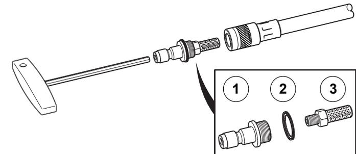
Die beiden Filter öfters reinigen, vorzugsweise nach jedem Arbeitsdurchgang.
