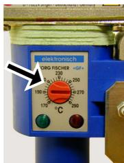
4. Richtige Schweißtemperatur am Heizelement einstellen mittels Temperatur-Einstellknopf ( $260\text{ °C} \pm 10\text{ °C}$  für PE, PP und PVDF).
