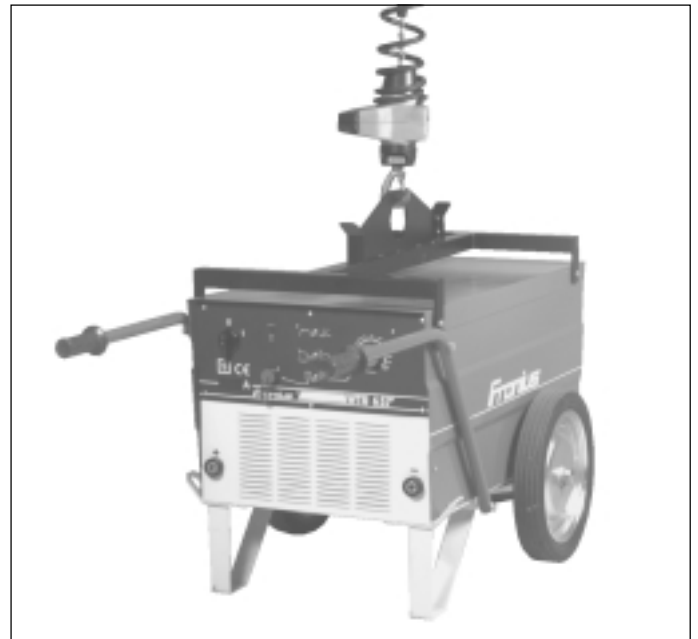
Abb. 7a Krantransport mit Einhaken - Kranaufhängung (Option)
