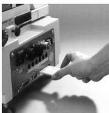
➔ Recordcard gemäss den Pfeilangaben auf der Recordcard und der Schnittstelle in die PCMCIA-Schnittstellenöffnung (Rückseite der Maschine) schieben, bis der Auswerfer herausgedrückt wird (Fig. 10.8.3.2).
