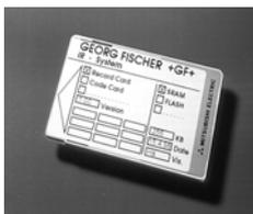
Mittels der integrierten PCMCIA-Schnittstelle ist eine papierlose Dokumentation möglich. Die Schweißdaten können vom Ringspeicher der Schweißmaschine auf die Recordcard (Speicherbaustein mit 256 KB Speicherkapazität) geladen werden. Die IR Plus® Recordcard (Fig. 10.8.3.1) hat eine Speicherkapazität von ca. 900 Schweißprotokollen.
