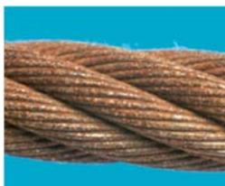
Abbildung 11: Äußere Korrosion
