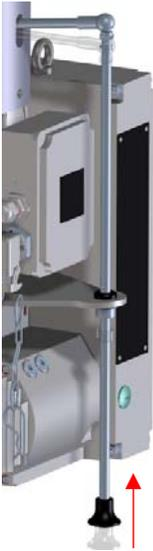
Winden die ausgeführt sind mit Bremslüftungsgestänge, können von unterhalb der Winde gelüftet werden.
