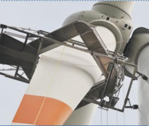
Einsatz in Rotorblattbefahranlagen
