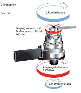
Die in der Grafik abgebildete Darstellung soll das Prinzip der Drehmomentvervielfältigung verdeutlichen. Nehmen wir ein Eingangsmoment von 100 N·m und ein Ausgangsmoment von 2500 N·m an. Bei z. B. einem Übersetzungsverhältnis von 1:25 sind am Eingang 25 Umdrehungen erforderlich, um am Ausgang ca. 1 Umdrehung mit einem Drehmoment von 2500 N·m zu erreichen. Begründet ist dies nach der physikalischen Formel:  $Leistung = Drehmoment \ x \ Drehzahl$
