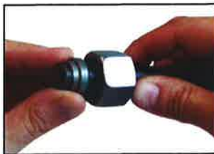
Abbildung 5: Position Schneidring, Überwurf-mutter, Rohr
