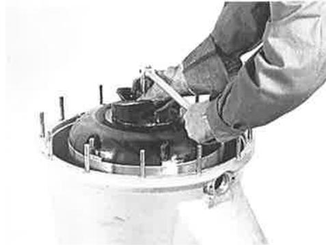
Eine Schraube 81 40 21 (M16) in die Gewindescheibe unter der Laufradschraube schrauben,
