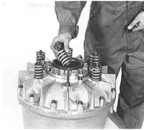
Das Saugsieb montieren.
