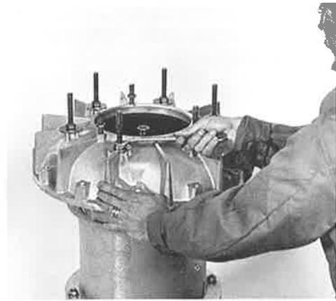
Das Laufrad, die Spezielscheibe in der Laufradnabe und die Scheibe und Laufradschraube montieren.
