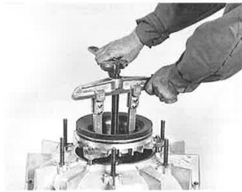
Die Laufradschraube abschrauben und die Scheibe entfernen.
