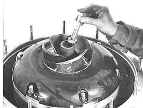
Die Schraube mit der Gewindescheibe montieren.
