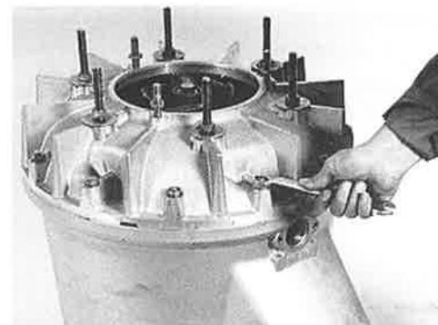
Wenn es schwierig ist, den Diffusor abzuheben, den Saugdeckel zurücksetzen und mit drei Muttern sichern. Den Diffusor mit dem Abzieher 84 13 60 abziehen.
