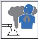
Vor der Durchführung von Schweißarbeiten an größeren Werkstücken in Form geschlossener Behälter oder mit nicht belüfteten Bereichen muss festgestellt werden, ob ein ausreichender Sauerstoffgehalt vorhanden ist (Sauerstoffgehalt der Umgebungsluft zwischen 19,5 und 23 %). Zu diesem Zweck wird der Einsatz eines Sauerstoffmessgerätes dringend empfohlen.
