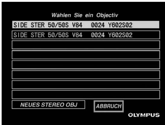
Diese Liste zeigt alle Seriennummer und Objektivnamen der registrierten Stereo-Objektive, die vom gleichen Typ wie das angeschlossene Stereo-Objektiv sind. Die gewählte Zeile in der Liste ist das Stereo-Objektiv, das bei der letzten Messung verwendet wurde.
