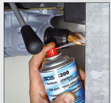
Schritt 2: Während des Bohrens Hochleistungs-fettspray auf die Bohrerspitze und in die Bohrung sprühen.
