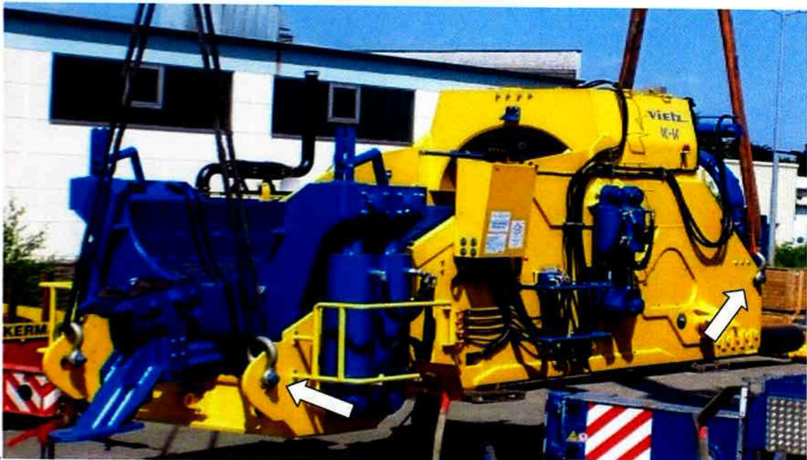
2. Sind die Laufwerke zum Transport demontiert worden, muss die RBM entsprechend der Montagehohe der Aufnahmebolzen gehalten werden. Gegebenenfalls ( siehe Punkt 2 ) die Laufwerke in folgender Reihenfolge montieren:
