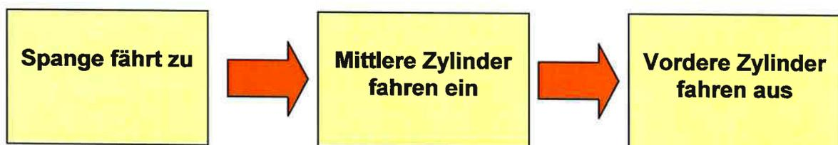
Nach dem Biegeschritt wird in umgekehrter Reihenfolge verfahren.
