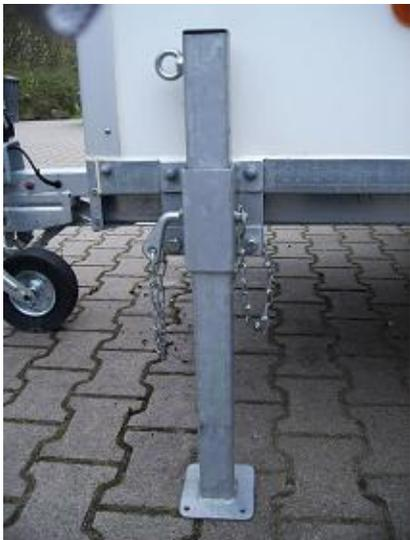
**Vordere Stützen ausfahren und Stützrad entlasten.**
