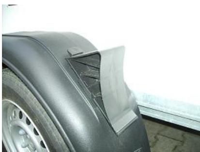
**Hemmschuhe unter beide Reifen legen, (nur bei Ausführung mit Auflaufbremse).**
