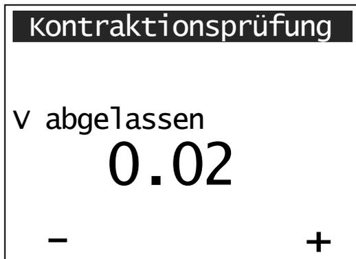
Der maximal zulässige Wasserverlust ( $V_{zul.}$ ) wird in Liter angezeigt.
