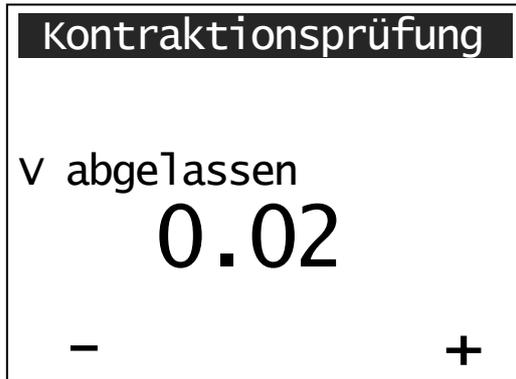
In der darauffolgenden Anzeige wird der maximal zulässige Wasserverlust ( $V_{\text{zul.}}$ ) in Liter angezeigt.
