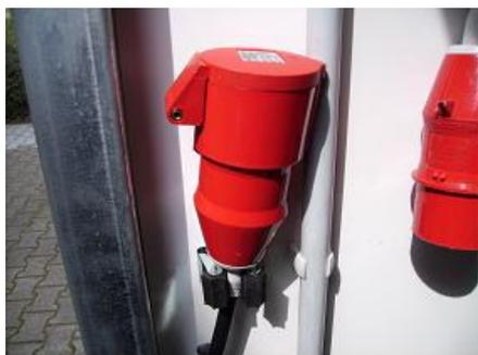
**Anschlusskabel mit CEE – Kupplung 400 Volt, 16 A mit Motorprüfpumpe verbinden und Stromversorgung der MPP herstellen.**
