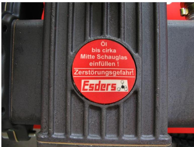
Warnhinweis für das Befüllen der Pumpe mit Spezialpumpenöl für MPP 28/68.
