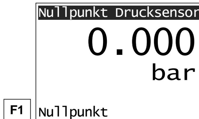
Liegen die Werte beim Setzen des Nullpunktes außerhalb der Toleranz (ca. 2% vom Messbereichsendwert) wird dies durch ein Signalton und einem Hinweis auf dem Display angezeigt.
