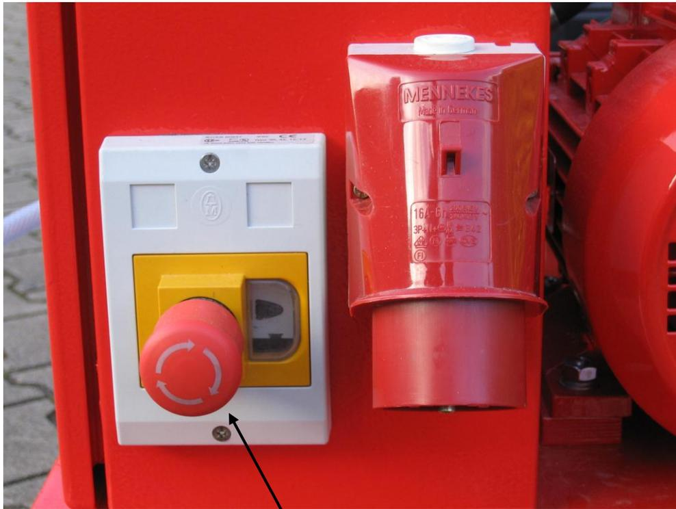
Not-Halt-Schalter für das sofortige Ausschalten der Pumpe im Notfall.
