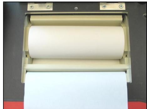
Betätigen Sie gegebenenfalls die Feed-Taste, bis das Papier gerade und sauber durch den Drucker läuft.
