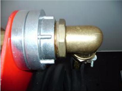
3. Motorprüfpumpe über Storz C-Kupplung mit Wasserschlauch verbinden.
