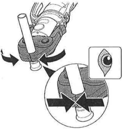
**6** Pressbacke vom Pressfitting lösen.
