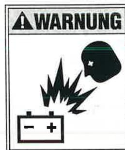
III ➔ Beim Laden der Starterbatterie entstehen explosive Gase.
