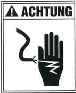
III ➔ Die Zündkreise von Benzinmotoren führen hohe Spannungen. Außerdem können im niederohmigen Batteriestromkreis hohe Ströme fließen.
