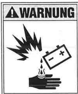
Batteriesäure ist stark ätzend. Beim Laden entstehen explosive Gase. Unachtsamkeit kann zu schweren Unfällen führen.
