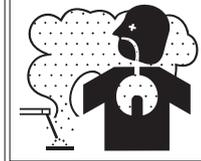
Beim Schweißen und Schneiden können giftige Dämpfe entstehen. Kommt der Lichtbogen mit chlorierten Lösungsmitteln in Berührung, kann das gefährliche Phosgen-Gas gebildet werden. Sind Werkstücke mit Blei, Kadmium, Zink, Quecksilber, Beryllium oder ähnlichen Stoffen beschichtet oder versetzt, können giftige Dämpfe hoher Konzentration entstehen. Auch Farbschichten oder -reste können bei Erhitzung giftige Dämpfe bilden.
