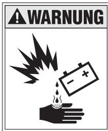
!!! Bei Batteriesäure ist stark ätzend. Beim Laden entstehen explosive Gase. Unachtsamkeit kann zu schweren Unfällen führen.
